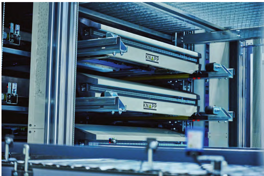
图5 所有的小型零件都集中存放在 OSR Shuttle Evo 小件仓库系统中，并能在生产需要时拣选配货，及时发往生产单元；或者作为零配件发给客户
