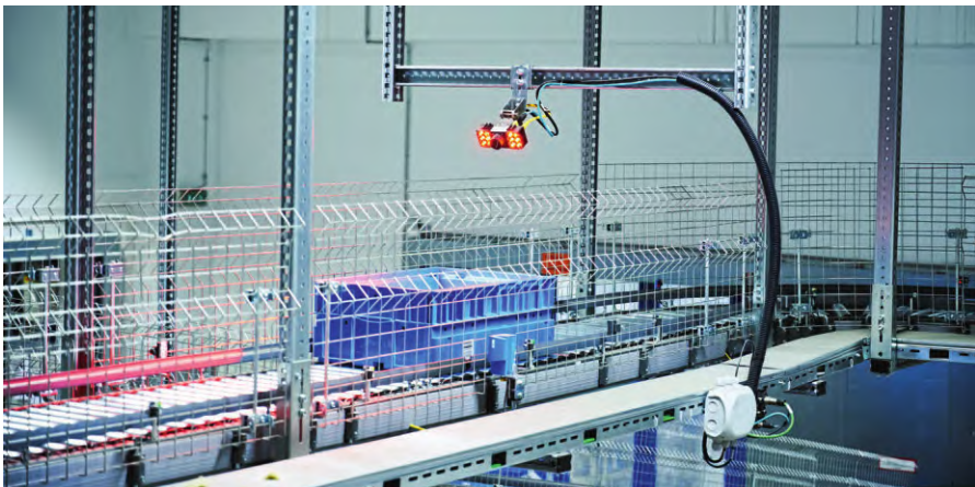
图 2 Pick-it-Easy-Flex 工作中易于操作、使用，并能通过电子标签分拣系统给物流员工提供最佳的支持和帮助
