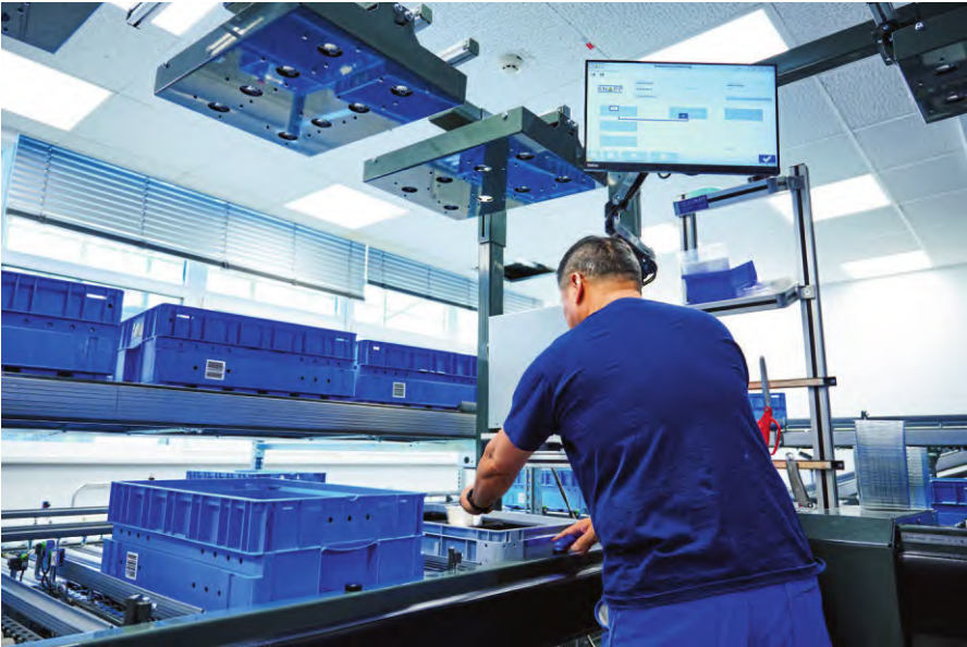
图 4 所有小型零件都集中存在 OSR Shuttle Evo 小件仓库系统中，并能在生产需要时拣选配货
