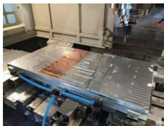
图10 冷板正面加工实景
