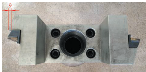
a) 刀座向刀具中心偏移铣削9mm
