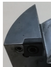
c) 刀片加工尺寸调整机构
