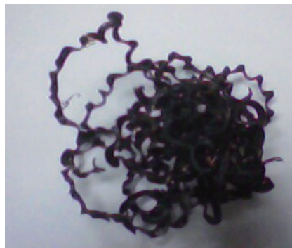
图3 堆积在前刀面上的切屑形态
