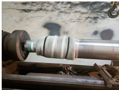
图12 车轴轮座喷钎后保温
