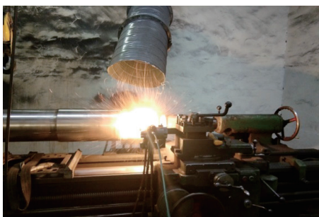
图2 线材火焰喷涂现场
