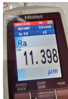
图8 表面粗糙度仪检测
