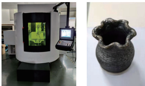
a) 五轴激光同轴丝材金属打印机 b) 打印金属花瓶 图6 五轴激光同轴丝材金属打印机和打印的金属花瓶
