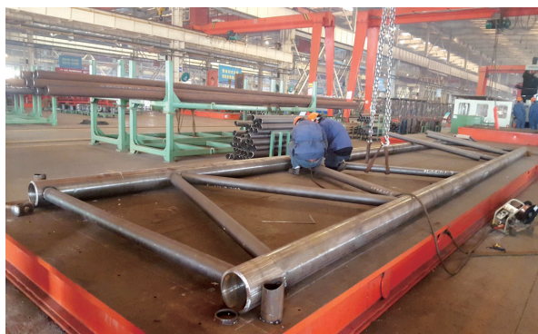
图3 生产流程二、生产流程三中桁架臂中间节组扇拼装及定位焊
