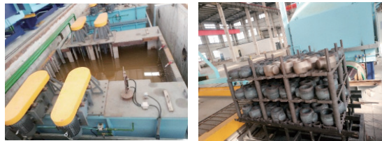
a) 快速淬火冷却系统
