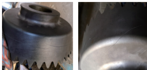
a) 裂纹形貌
