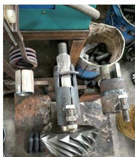
图3 增加限位螺栓定位
