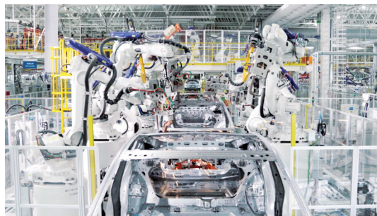
图2 小鹏焊装生产线
