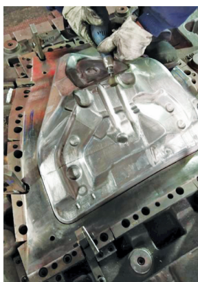
图 9 放大圆角，提升表面粗糙度
