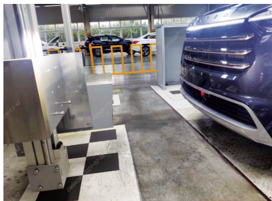
图4 车辆下线后驶入 ADAS 标定台
