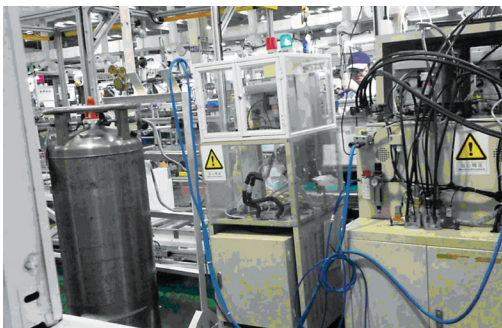
图4 增加散热器总成的气密性检查
