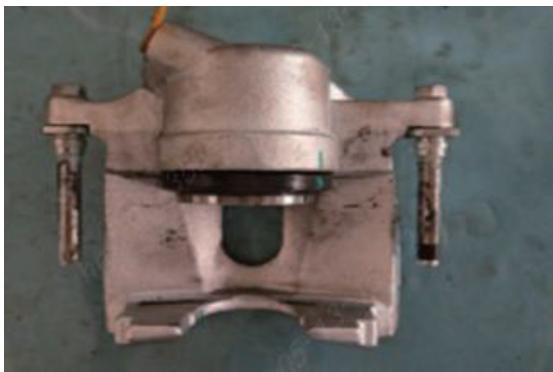
图2 异响卡钳拆解分析图
