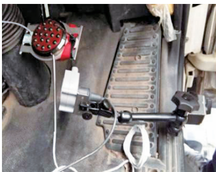
图 1 踏板力 / 位移测量系统测量端
