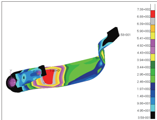
图 3 制动踏板 2 000 N 作用应力分布
