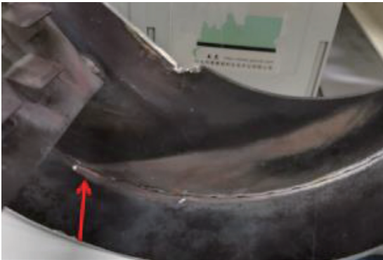
图 2 混合器拆解图
