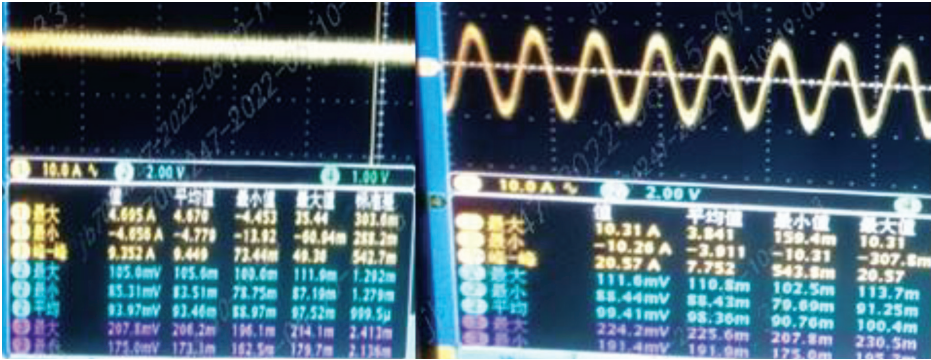
图 2 IGBT 开管时和带载时母线上交流峰峰值（左：开管，右：带载）
