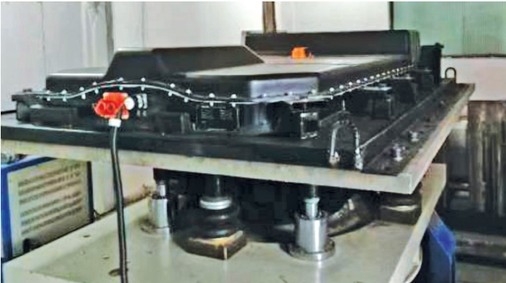
图 7 动力电池包振动测试
