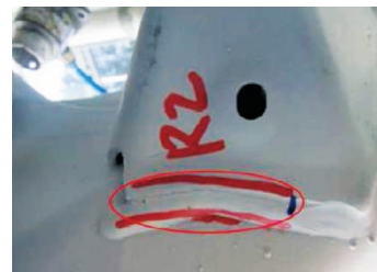
图7 副车架多通道裂纹 2
