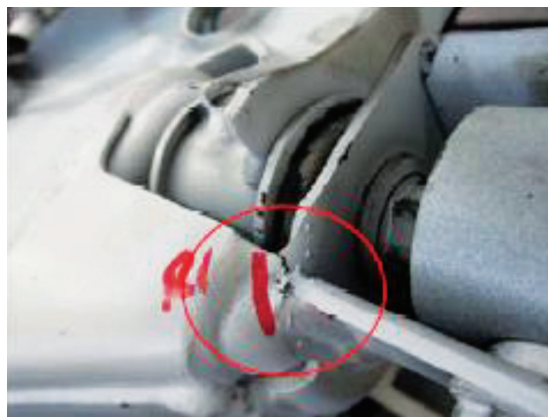
图6 副车架多通道裂纹 1
