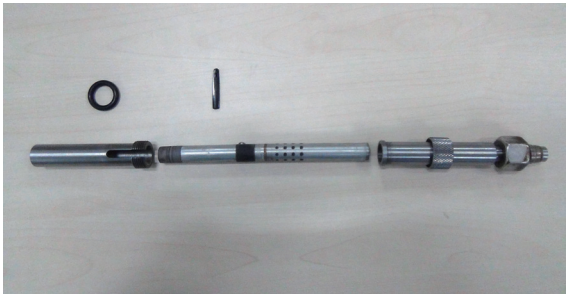
图5 模拟喷头实物拆解
