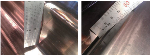
a) 拉伸凹模 b) 拉伸凸模
