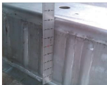
c) 测量侧壁形状
