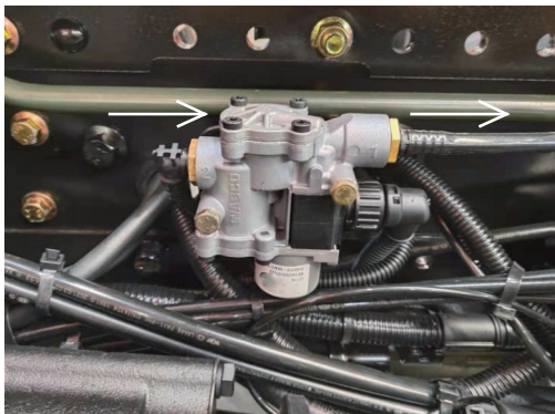
图18 ABS电磁阀及反接的气路方向
