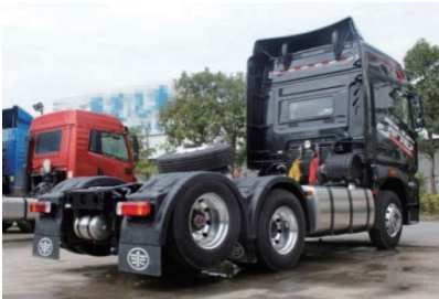
图1 采用六通道ABS的后提升重型货车
