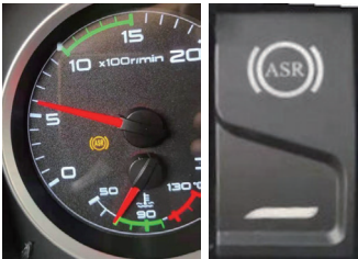
图12 ASR警报灯和取消开关
