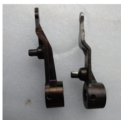
图9 两种方案的换挡摇臂样件对比
