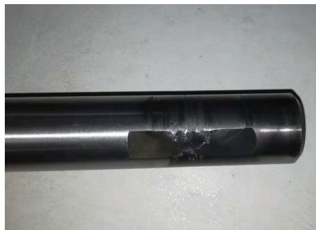
a) 改进前，行星齿轮轴拉毛
