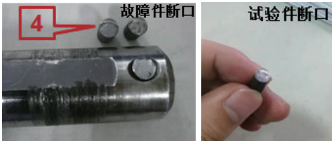
图4 锁销故障件及试验件对比
