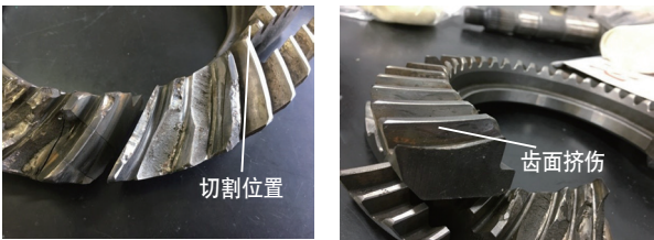
图4 从动齿轮切割部位及齿面挤伤宏观形貌
