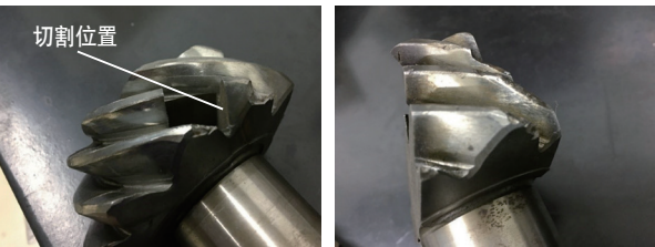
图2 主动齿轮切割部位及擦伤宏观形貌
