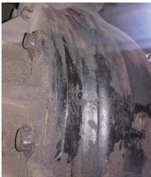
图2 减壳配合面漏油
