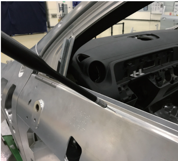
a) 接触式三坐标测量
