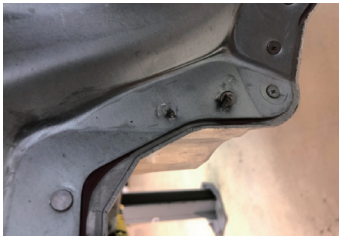
图4 凸起铆钉与机器人碰撞导致零件二次受损
