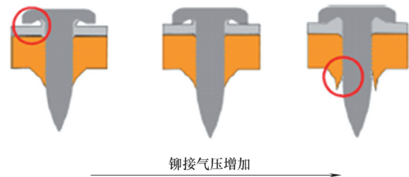
图9 铆接气压过小/过大对质量的影响
