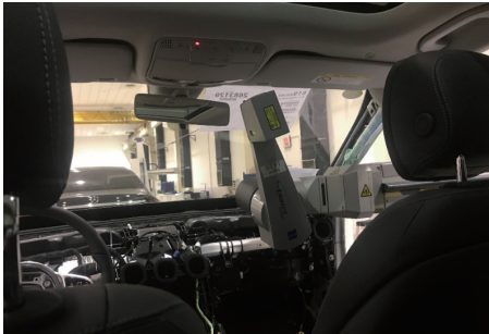
图4 EagleEye探头切换直接测量
