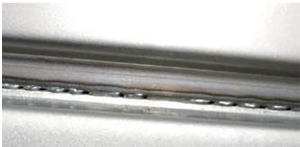
图7 锯齿状焊接结果
