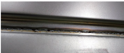
图6 由于镀锌层而出现的匙孔现象图
