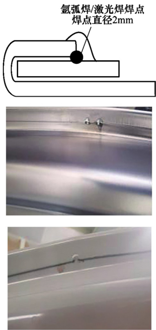
图7 氩弧焊、激光焊焊接区域
