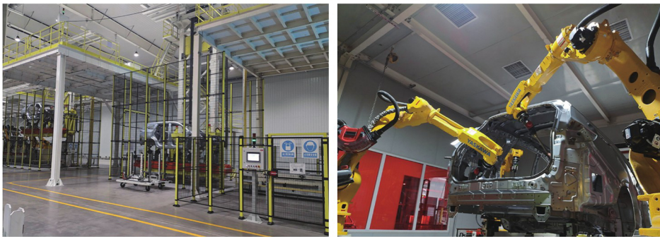
图8 MB2、MB3线间建立缓存，机器人弧焊模块单独成线
