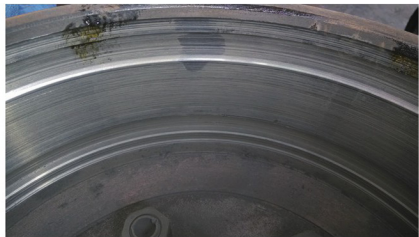
图2 制动鼓内表面周向凹槽
