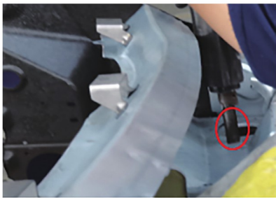
图8 通风室与前轮罩SPR连接
