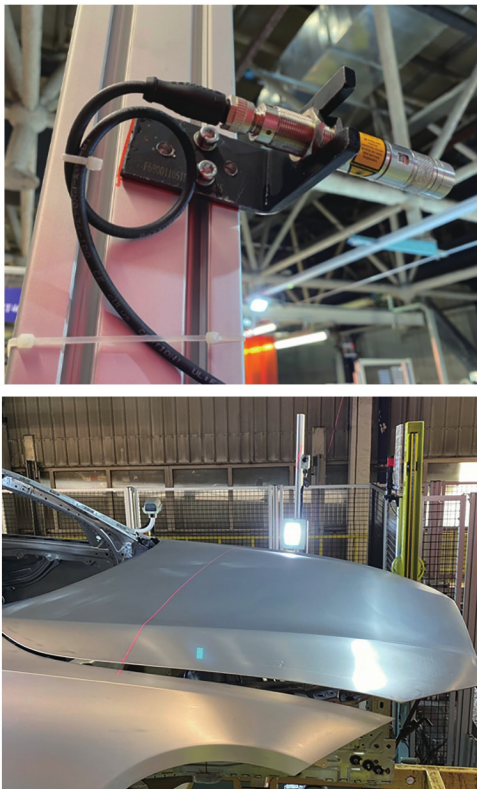
图10 激光光源与视觉传感器的安装示意
