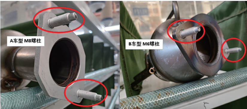
图1 A车型和B车型后催化器螺柱
