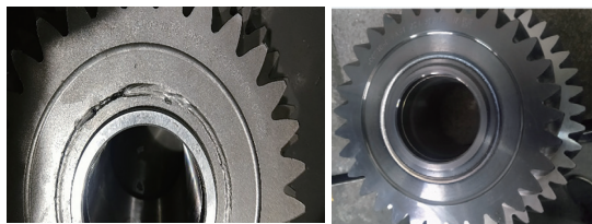
a) 改进前 b) 改进后 图1 改进前后焊接表面弧坑质量
