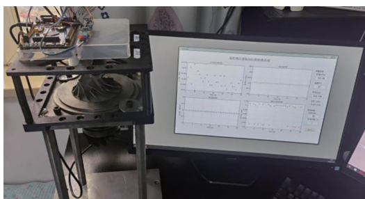
图10 涡轮增压器轴向位移检测系统实物
