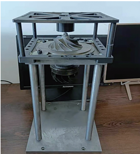
图8 检测系统与涡轮增压器转子设备
