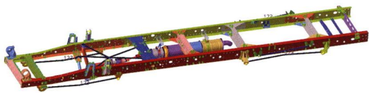
图2 排气系统模态分析有限元模型
