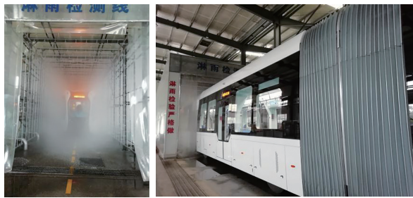
图10 智轨电车防雨密封性试验示意
