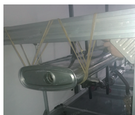
图7 单层消声器模态测试
