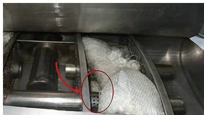
图2 故障消声器解剖
