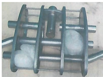
图1 后消声器内部结构
