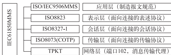
图2 TCP/IP结构与OSI模型对照
