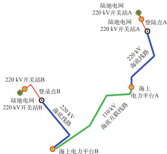
图1 海上油田群岸电供电结构示意图
