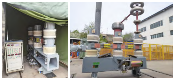
图10 机械寿命试验照片
