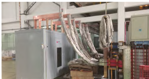
图8 温升试验形态简图
