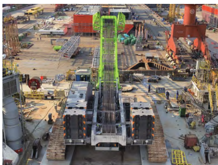
图5 平台上布置履带起重机
