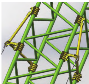
图10 履带起重机臂杆缆风架安装三维示意图
