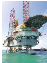
图2 三角桁架式桩腿自升式钻井平台
