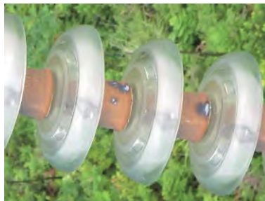
图6 绝缘子串上的闪络痕迹
