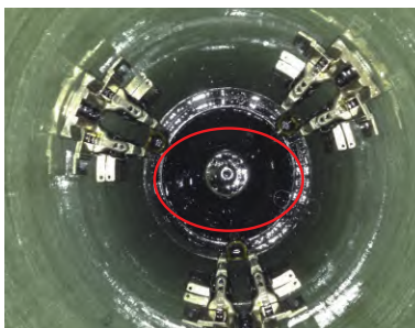
图4 绝缘筒底部放完油后聚集大量游离碳，壁表面干净
